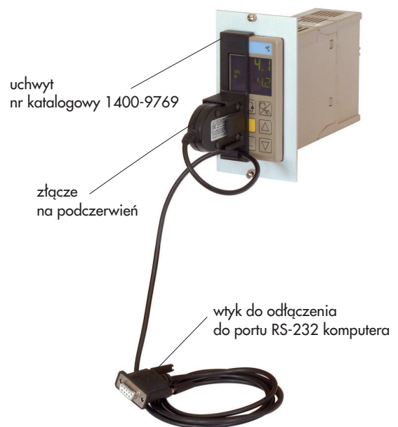
Rys. 4: Podłączenie złącza na podczerwień
