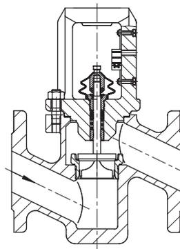
**Bild 6:** Schmiedeventil Typ 3241 PSA, DN 15 bis 80
