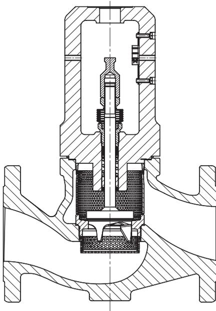
**Bild 4:** Ventil Typ 3241 PSA, DN 15 bis 150, mit Strömungsteiler St I PSA
