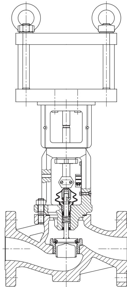
**Bild 5:** Stellventil Typ 3241-9 PSA, DN 15 bis 150, mit pneumatischem Kolbenantrieb Typ 3275
