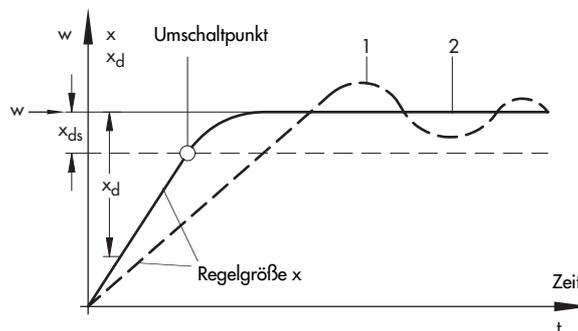
Bild 7 · Anfahr diagramme von Temperaturregelungen
