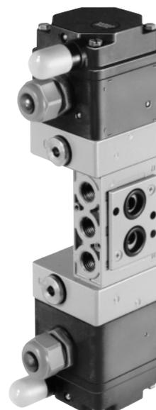
5/2-Wege-Magnetventil, beidseitig angesteuert, mit 2 rastenden Stellungen,  $K_{vs}$ -Wert 1,4, Anschluss G  $1/4$ /NAMUR
