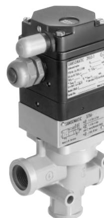
3/2-Wege-Magnetventil, einseitig angesteuert, mit Federrückstellung,  $K_{vs}$ -Wert 4,3, Anschluss G  $1/4$
