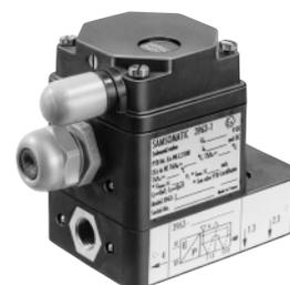
5/2-Wege-Magnetventil, einseitig angesteuert, mit Federrückstellung,  $K_{vs}$ -Wert 0,16, Anschluss G  $1/4$
