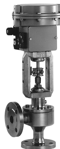
Rys. 2 · Zawór regulacyjny typu 3249-7 w wykonaniu specjalnym z dławnicą awaryjną, korpus z pełnego materiału z kołnierzami, z siłownikiem pneumatycznym typu 3277-5 i zintegrowanym ustawnikiem pozycyjnym i/p typu 3767.
